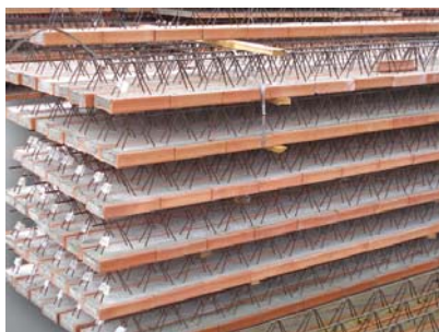
Арматурный каркас несущей балки
